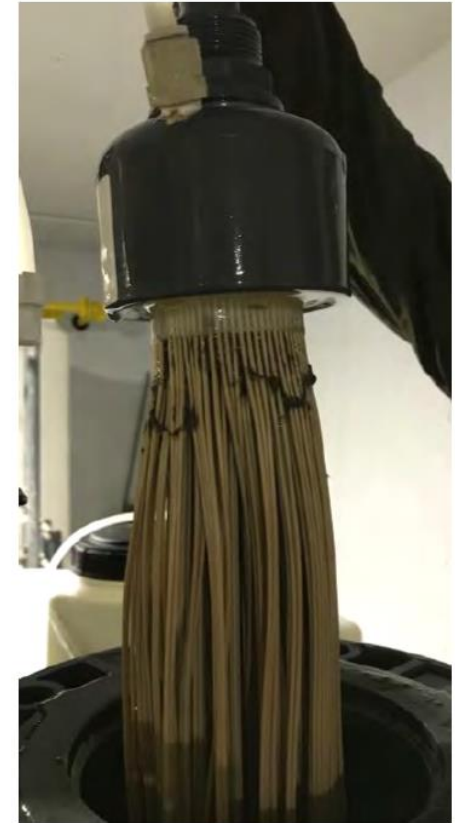
10 Square Foot Membrane Module
